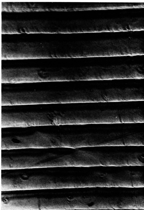
Abb. 2. Selektiver elektrolytischer Abtrag einer Si-Probe bei 100-facher Vergrößerung.
